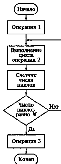
Рис. 17.3. Схема циклического алгоритма
