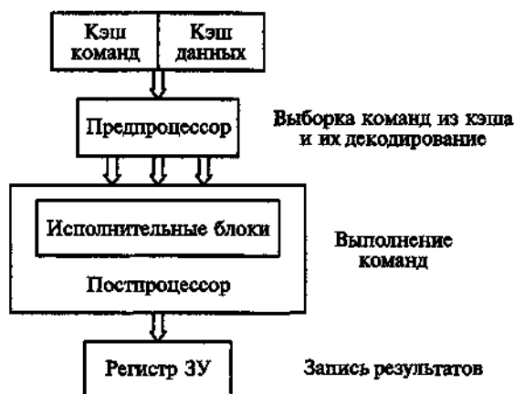
Рис. 8.5. Конвейер обработки команд
