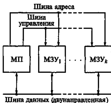
Рис. 13.2. Интерфейс с двунаправленной шиной (многомодульная организация памяти)
