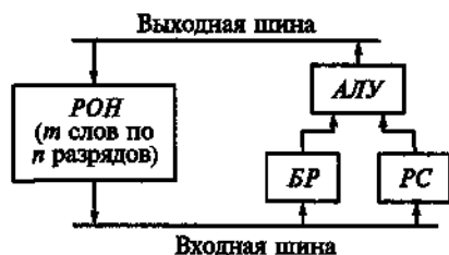
Рис. 9.8. Упрощенная структурная схема обрабатывающей части микропроцессора
